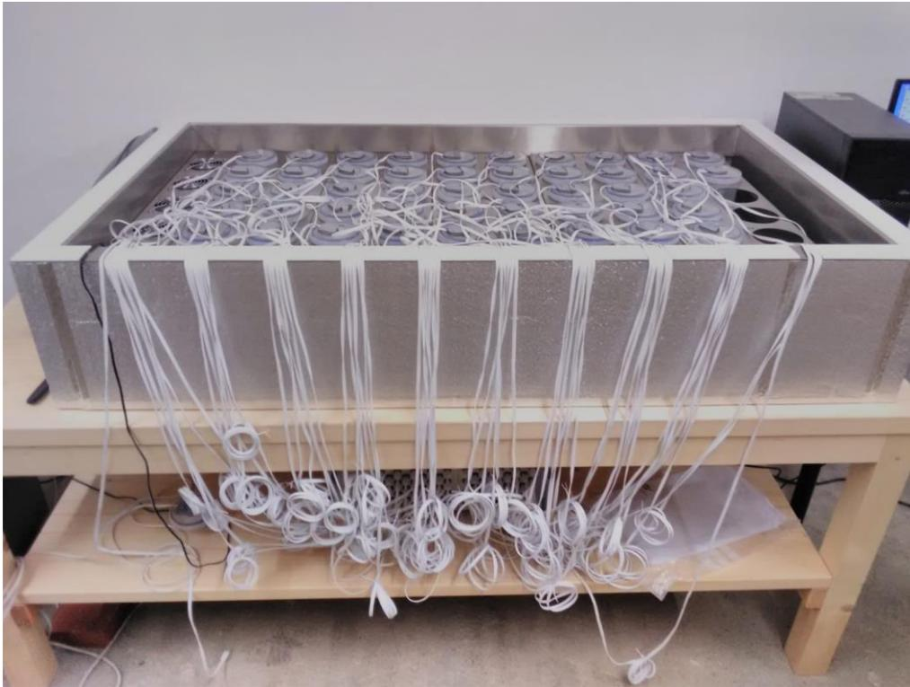
Abbildung 2. CarbOBot: Behälter im Wasserbad und Messeinheit.
