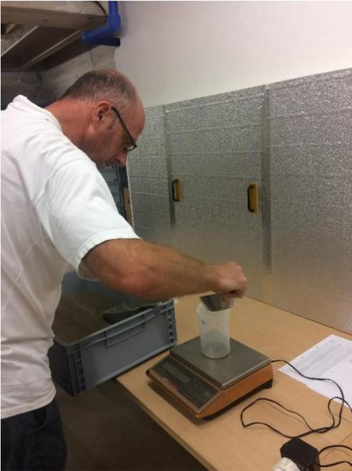
Abbildung 5: Befüllen der Probengefäße mit 100 g Boden.
